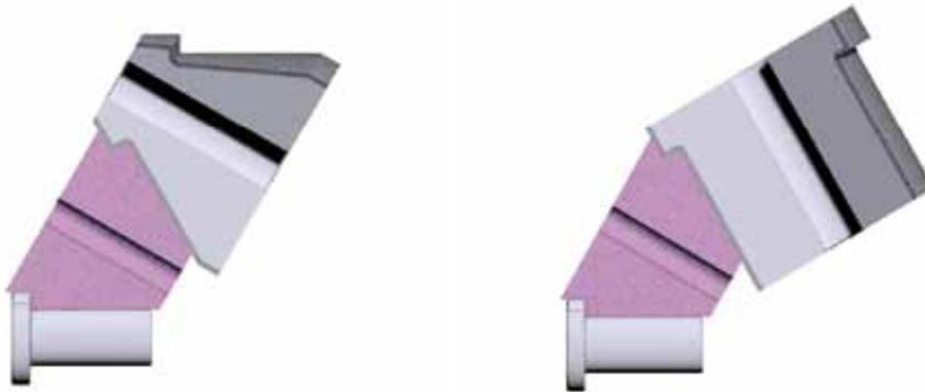
Los ejes del rodillo y la muela son paralelos entre sí, pero en ángulo con el eje de la pieza. El ataque del rectificado es en ángulo recto al eje de la muela.
